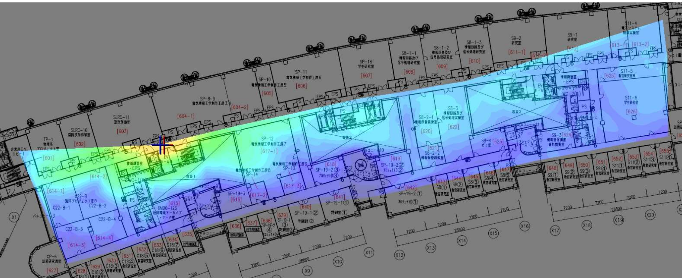
ワイルド分布で推定誤差が 0.846[m] ケースの推定結果の様子 (計測点106番)
